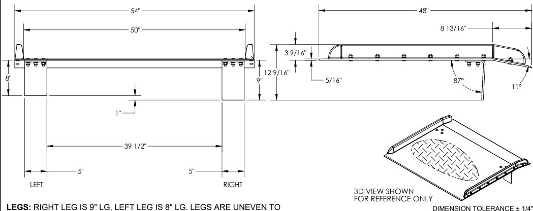
**LEGS:** RIGHT LEG IS 9" LG, LEFT LEG IS 8" LG. LEGS ARE UNEVEN TO CREATE A GAP SO DOCKBOARD CAN BE PICKED UP BY A FORK LIFT
