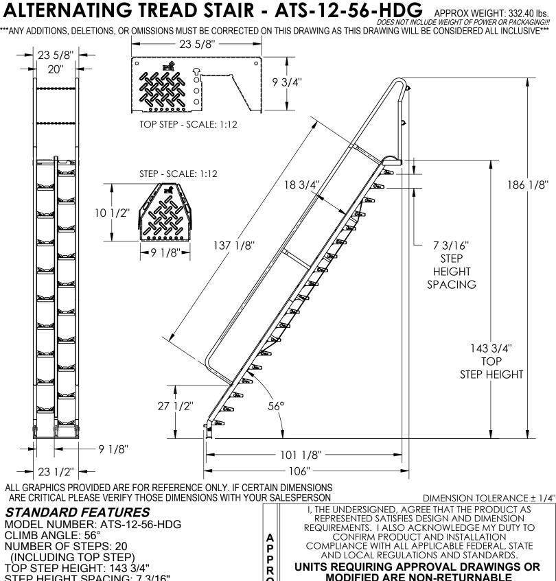
STEP HEIGHT SPACING: 7 3/16" HANDRAIL HEIGHT: 18 3/4" OVERALL HEIGHT: 186 1/8" OVERALL LENGTH: 106" OVERALL WIDTH: 23 1/2" CHAIN GATES AT TOP STEP RUBBER BUMPER STRIP MAX CAPACITY IS 350 LBS HOT DIPPED GALVANIZED FINISH HANDRAILS ARE TOUGH BAKED IN POWDER COATED YELLOW FINISH SPECIAL FEATURES
