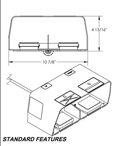
MODEL NUMBER IS FC-2 **OVERALL WIDTH IS 10 7/8" USABLE LENGTH IS 5 3/4" OVERALL HEIGHT IS 4 13/16"** APPROXIMATE 8 ft. USABLE CORD LENGTH WITH 3-PIN CONNECTOR FOOT CONTROL GUARD IS TOUGH BAKED IN POWDER COATED YELLOW FINISH
