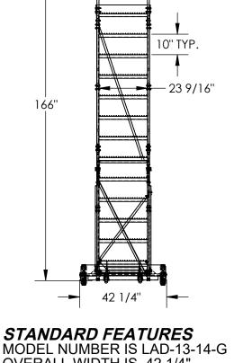
OVERALL WIDTH IS 42 1/4" USABLE WIDTH IS 23 9/16" **OVERALL LENGTH IS 95 9/16" USABLE LENGTH IS 91 5/16" OVERALL HEIGHT IS 166"** TOP STEP HEIGHT IS 130" STEP TYPE IS GRIP STRUT CLIMB ANGLE IS 58° STEP DEPTH IS 7" **TOP STEP DEPTH IS 14"** MAX CAPACITY IS 350 LBS WHEEL SIZE IS Ø10" FRONT WHEEL SIZE IS Ø 3" TOUGH BAKED IN POWDER COATED BLUE FINISH
