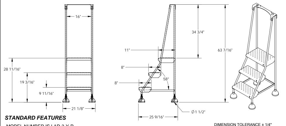
MODEL NUMBER IS LAD-3-Y-P **OVERALL WIDTH IS 21 1/8" USABLE WIDTH IS 16" OVERALL LENGTH IS 25 9/16" OVERALL HEIGHT IS 63 7/16"** CAPACITY IS 300 LBS
