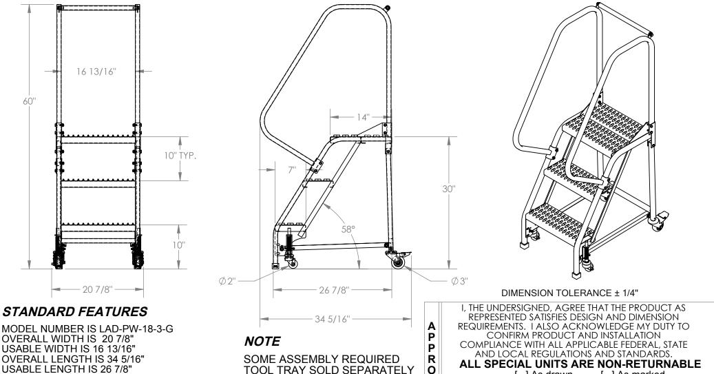
OVERALL WIDTH IS 20 7/8" **USABLE WIDTH IS 16 13/16"** OVERALL LENGTH IS 34 5/16" **USABLE LENGTH IS 26 7/8" OVERALL HEIGHT IS 60"** PLATFORM HEIGHT IS 30" **COLOR IS VESTIL BLUE** STEP TYPE IS GRIP STRUT CLIMB ANGLE IS 58°
