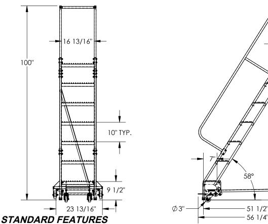
MODEL NUMBER IS LAD-PW-18-7-G OVERALL WIDTH IS 23 13/16" **USABLE WIDTH IS 16 13/16" OVERALL LENGTH IS 56 1/4" USABLE LENGTH IS 51 1/2" OVERALL HEIGHT IS 100"** PLATFORM HEIGHT IS 70" STEP TYPE IS GRIP STRUT CLIMB ANGLE IS 58° STEP DEPTH IS 7" PLATFORM DEPTH IS 14"
