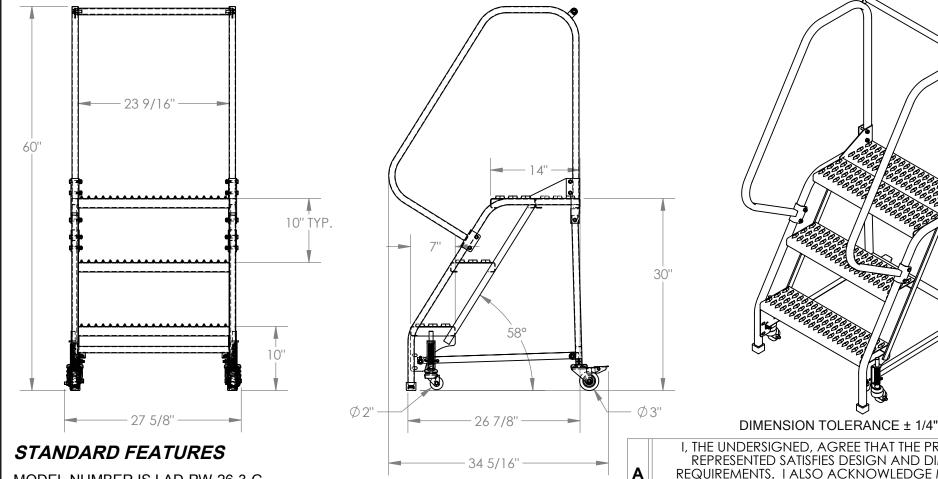
MODEL NUMBER IS LAD-PW-26-3-G OVERALL WIDTH IS 27 5/8" USABLE WIDTH IS 23 9/16" OVERALL LENGTH IS 34 5/16" **USABLE LENGTH IS 26 7/8" OVERALL HEIGHT IS 60"** PLATFORM HEIGHT IS 30" COLOR IS VESTIL BLUE STEP TYPE IS GRIP STRUT CLIMB ANGLE IS 58° STEP DEPTH IS 7" PLATFORM DEPTH IS 14" MAX CAPACITY IS 350 LBS FRONT Ø2" DIRECTIONAL SPRING-LOADED SWIVEL CASTERS
