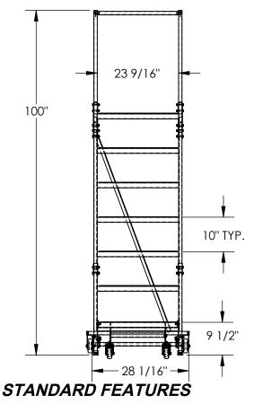
MODEL NUMBER IS LAD-PW-26-7-P **OVERALL WIDTH IS 28 1/16"** USABLE WIDTH IS 23 9/16" **OVERALL LENGTH IS 56 5/16" USABLE LENGTH IS 51 1/2" OVERALL HEIGHT IS 100"** PLATFORM HEIGHT IS 70" STEP TYPE IS PERFORATED CLIMB ANGLE IS 58° STEP DEPTH IS 7" PLATFORM DEPTH IS 14"
