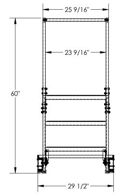
STANDARD FEATURES MODEL NUMBER IS LAD-TRN-50-3-FDA OVERALL WIDTH IS 29 1/2" USABLE WIDTH IS 23 9/16" OVERALL LENGTH IS 38 1/2" USABLE LENGTH IS 38 1/2" USABLE LENGTH IS 33" OVERALL HEIGHT IS 60" PLATFORM HEIGHT IS 30" STEP TYPE IS PERFORATED CLIMB ANGLE IS 50° STEP DIMENSION IS 24" x 7" TOP STEP DIMENSION IS 24" x 14" MAX CAPACITY IS 350 LBS TOUGH BAKED IN POWDER COATED FDA COMPLIANT WHITE FINISH
