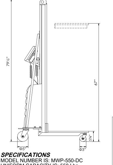
UNIFORM CAPACITY IS: 550 Lbs. OVERALL WIDTH IS: 23 5/8" OVERALL LENGTH IS: 35 1/2" OVERALL HEIGHT IS: 79 1/2" PLATFORM WIDTH IS: 23 5/8" PLATFORM LENGTH IS: 18 1/2" PLATFORM SERVICE RANGE IS: 5 1/4" - 67" TOUGH BAKED IN POWDER COATED BLUE FINISH
