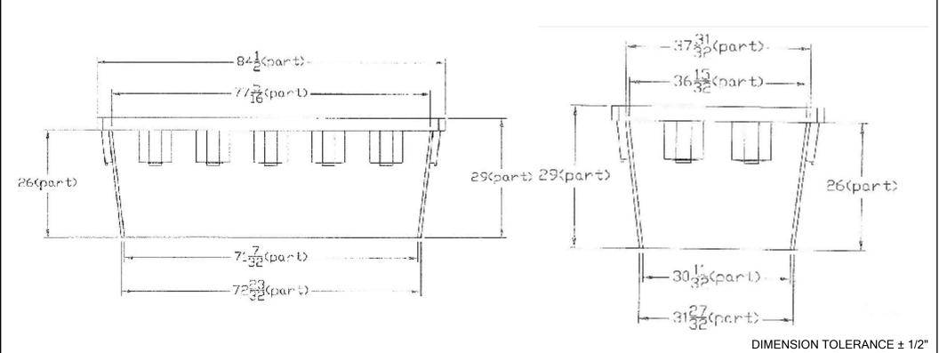
MODEL NUMBER: OTC-275 MAXIMUM CAPACITY 360 GAL USABLE HEIGHT 26" USABLE WIDTH 36 15/32" USABLE LENGTH 77 5/16
