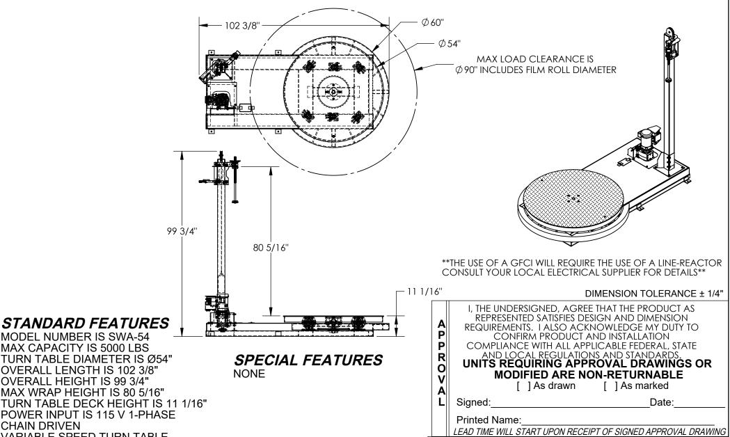
MAX CAPACITY IS 5000 LBS TURN TABLE DIAMETER IS Ø54" **OVERALL LENGTH IS 102 3/8" OVERALL HEIGHT IS 99 3/4"** MAX WRAP HEIGHT IS 80 5/16" TURN TABLE DECK HEIGHT IS 11 1/16" POWER INPUT IS 115 V 1-PHASE CHAIN DRIVEN
