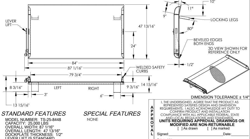
LEVER LIFT IS STANDARD LOCKING LEGS ARE 6" WIDE RIGHT LEG LENGTH IS 9 3/16" LEFT LEG LENGTH IS 8 3/16"
