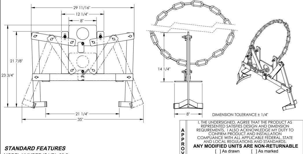
MODEL NUMBER IS VDL-22.5 **OVERALL WIDTH IS 8" OVERALL LENGTH IS 29" USABLE LENGTH IS 35" EXTENDED HEIGHT IS 22 1/2" RETRACTED HEIGHT IS 24"**
